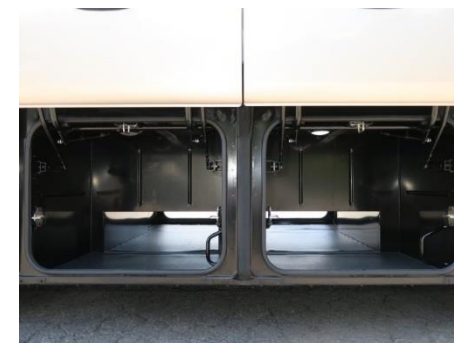
室外トランク
